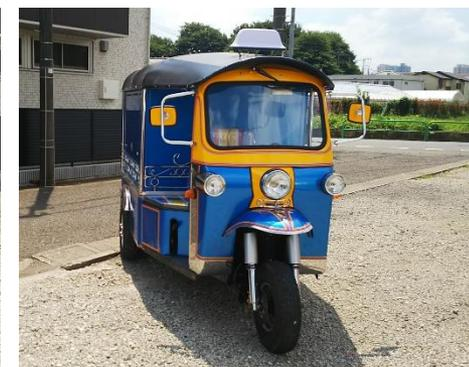
ベース車両：トゥクトゥク 走行移動時外寸 長さ 3220 幅1370 高さ1850 (車内高 1150)
