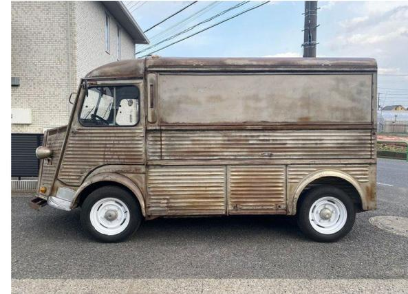
車両：シトロエンHバン 走行移動時外寸 長さ 4260 幅1990 高さ2250 (車内高 1830)
