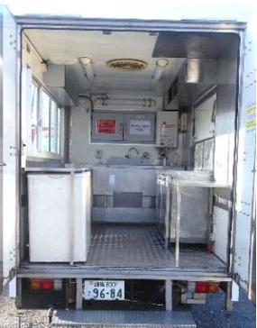
ベース車両：マツダボンゴ 走行移動時外寸 長さ 4850 幅1830 高さ2850 (車内高 1850)
